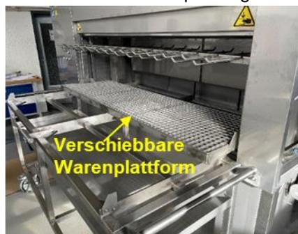
Abb.: Transportwagen mit verschiebbarer Warenplattform
