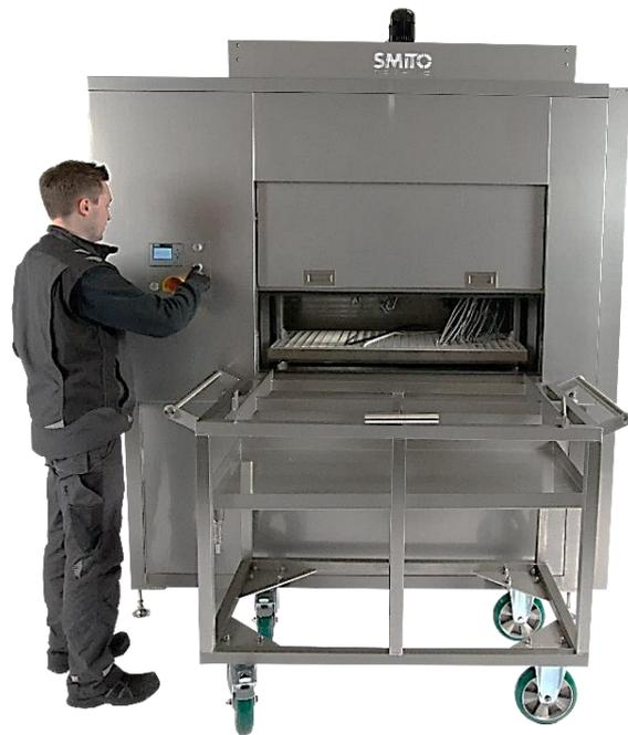
Beim Arbeiten mit dem Entlackungsvollautomat findet kein direkter Kontakt mit der Chemie statt. Durch den Anschluss an ein Absaugsystem treten keine Dämpfe aus und eventuelle Gerüche werden direkt abgesaugt.
