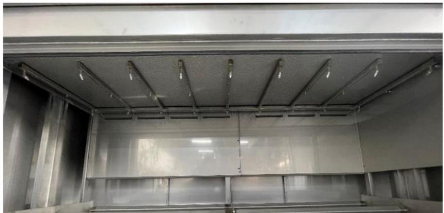
Abb: Option: Frischwasserspülung, mit Düsensystem und Schutzblechen
