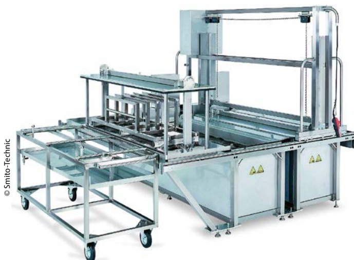
Die Multibeckenanlage umfasst ein Tauchentlackungsbecken, ein Spülbecken, ein Transportportal, Warenträger und Fahrwagen.
